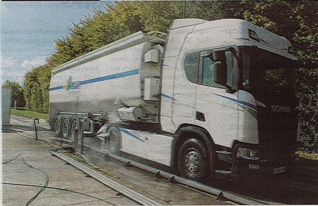
A Alifel, sur la nouvelle piste, le conducteur doit d'abord badger pour déclencher le cycle de lavage de son camion (bas de caisse jusqu'à 1 m de haut et roues), puis le cycle de désinfection grâce aux buses placées au sol.
